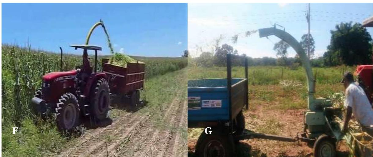
Figura 5. Colheitadeira e ensiladeira mecânica (F) e ensiladeira de corte manual (G).
